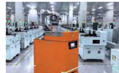
Die Bonder Loading/Unloading
